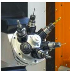
Revolver-Werkzeugkopf für 6 Werkzeughalter der Serie WF 35, horizontal montiert, Spindeldrehzahl 10000 min<sup>-1</sup>, Drehung von Werkzeug zu Werkzeug (60°) mit Torque-Servomotor in ca. 1 Sek.
