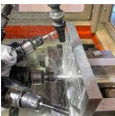
Integriertes Kreislauf-Kühlsystem mit internem 85-Liter-Tank und Filter
