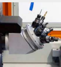
Revolver-Werkzeugkopf für 6 Werkzeughalter der Serie WF 35, horizontal montiert, Spindeldrehzahl 18000 min<sup>-1</sup>
