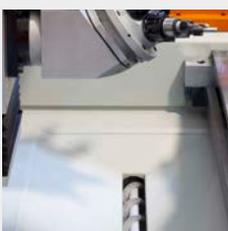
Integrierte Spanabfuhr (Förderschnecke) mit Seitenklappe für externe Spänesammlung
