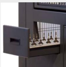
Manueller Werkzeugwechsel aus integrierten Werkzeugmagazinen (seitliche Schubläden links und rechts für je 12 Werkzeuge)
