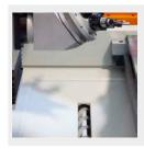
Evacuation des copeaux intégrée (vis sans fin) avec trappe latérale pour la collecte externe des copeaux
