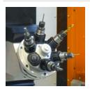
Tête d'outil revolver pour 6 porte-outils de la série WF 35, monté horizontalement, vitesse de rotation de la broche 10 000 min<sup>-1</sup>, rotation d'outil à outil (60°) avec servomoteur à couple en 1 sec. env.
